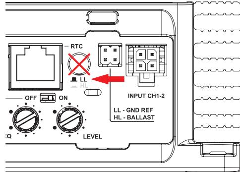
**Ingressi a basso livello** - i ponticelli devono essere utilizzati solo se la sorgente del segnale esterno non è alimentata dalla batteria dell'auto, ad esempio DAP, smartphone, ecc... L'uso di ponticelli in una configurazione diversa può causare loop di massa e ronzi.
